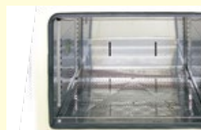
底面吸い込み循環型の槽内
