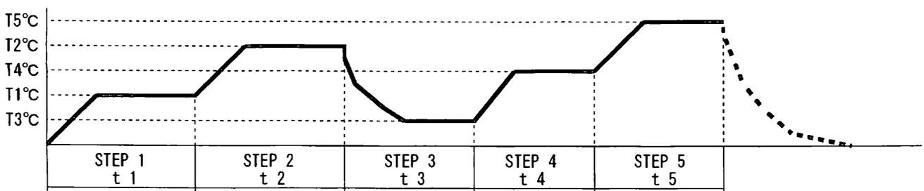
5つのステップがあり、各ステップ毎に温度と時間を設定して運転開始 (RUN) すると、ステップ1から ( $T_1$ )  $^{\circ}\text{C}$ で ( $t_1$ ) 時間の運転が始まります。ウェイトがないため (RUN) と同時に計時が始まるので、昇温に要する時間も ( $t_1$ ) に含まれ、( $t_1$ ) 時間が経過するとステップ2に移って、ステップ1と同じように ( $T_2$ )  $^{\circ}\text{C}$ で ( $t_2$ ) 時間の運転を行い、以下ステップ3, 4, 5と進み、ステップ5の ( $t_5$ ) が経過したところで自動的に運転を終了する運転モードです。
