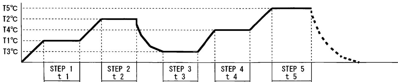
5つのステップがあり、各ステップ毎に温度と時間を設定して運転開始（RUN）すると、ステップ1から（ $T_1$ ）℃で（ $t_1$ ）時間の運転が始まります。
