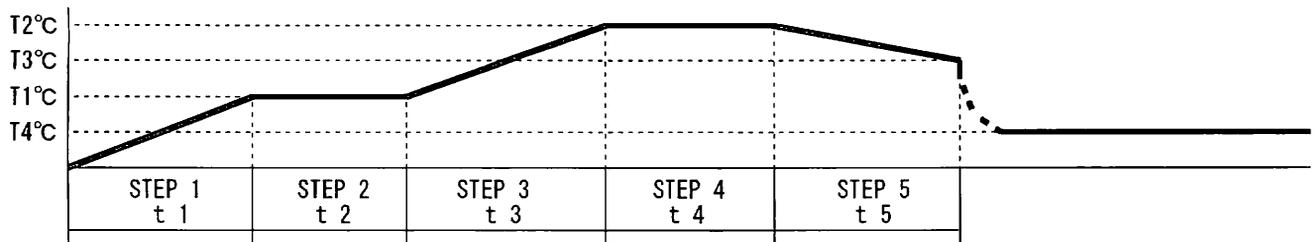
基本的には前項(2.8)と同様の運転モードですが、プログラム作成時に運転終了時の温度(T4)を指定するとステップ5の(t5)が経過した後に(T4)を”STOP”キーが押されるまで維持し続けられる運転モードです。
