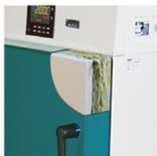
発泡プラスチック断熱材、ロックウール、グラスウールの3重層でできた扉
