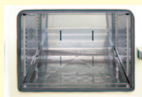
底面吸い込み循環型の槽内
