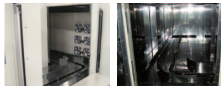
槽内コンベアレーン
