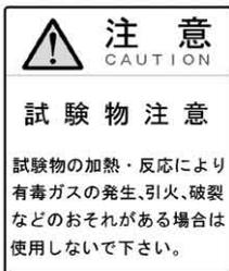
自己発熱をする物質や、異種混合物質で反応熱が発生するような物質は絶対に槽内に入れないでください。火災の原因になります。
