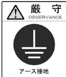
◎漏電による感電事故を避けるため必ずアース線を接続してください。
