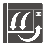
内槽底面 吸い込み式
